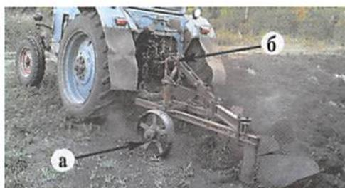
1. С помощью механизма регулировки опорного колеса рамы (а).
