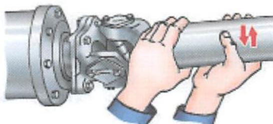
4. Как следует располагать вилки карданной передачи при присоединении сельскохозяйственных машин к ВОМ трактора?
